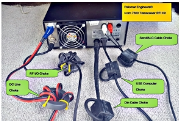
Ejemplo de uso de Ferritas en un set up de radio
